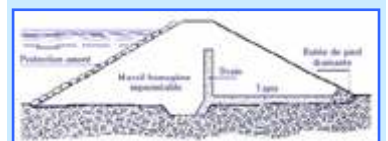
Le barrage en remblai
